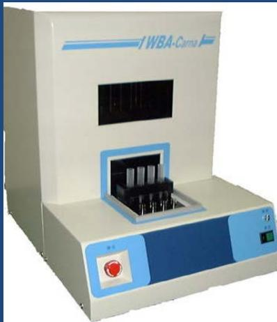
此儀器並非測量血小板的數量，而是檢測血小板的功能，測定其凝血能力
